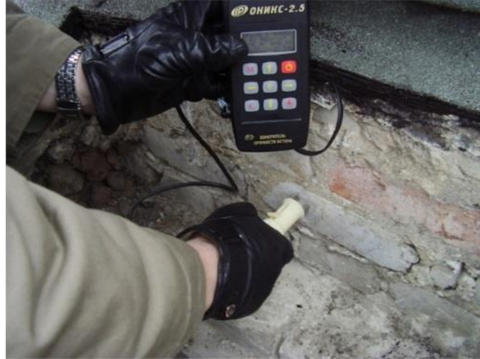
Şəkil 3. Bünövrənin alətlərlə müayinəsi (betonun dağıdıcı olmayan üsulla möhkəmliyinin təyini).
