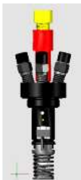
Şəkil 1. Dozalayıcı mexanizmin quruluş sxemi.
