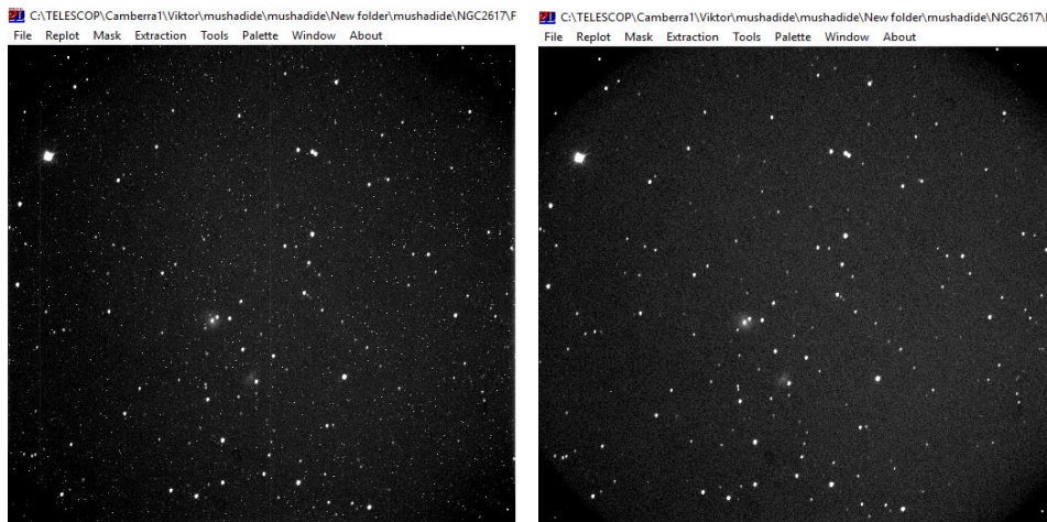
Şəkil 5. Fotometrik təsvirlərin isti piksellərdən təmizlənməsi. Sol panel təmizlənməmiş kadr, sağ panel isti piksellərdən təmizlənməmiş kadr.
