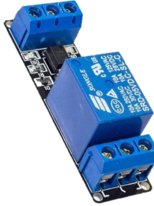
Şəkil 7. 5V təkkanallı rele
