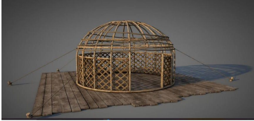
Şəkil 5. Yurtanın daşıyıcı elementlərinin 3D görünüşü
