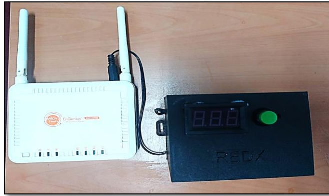
Şəkil 1. Fasiləsiz enerji mənbəyinin modema qoşulması.
