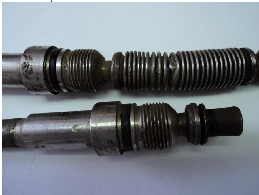
Şək.1.5. Qazlift klapanının imtina etmiş silfon düyünü
