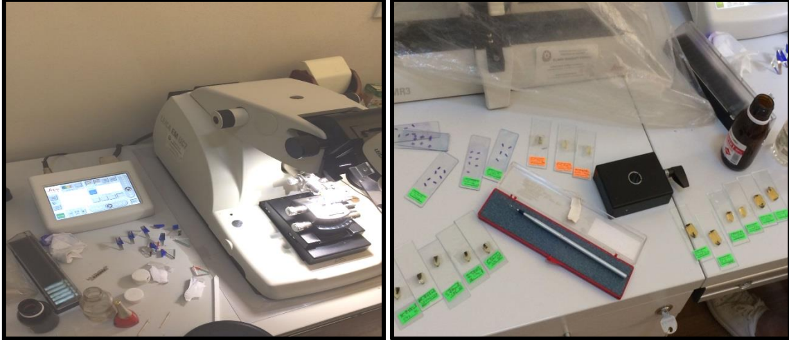
Şəkil 1. Araldit-epon bloklarına yerləşdirilmiş və "ultratom"da kəsilməyə hazırlanan preparatlar
