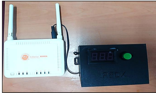
Şəkil 1. Fasiləsiz enerji mənbəyinin modema qoşulması.
